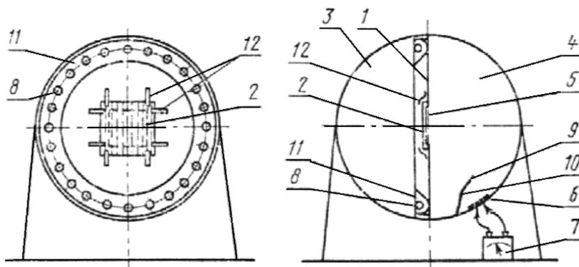
1 - диафрагма; 2- образец; 3, 4 - полусферы диффузометра; 5 - отверстие в диафрагме; 6 - фотоэлемент; 7 - люксметр; 8 - источники света; 9- экран, предохраняющий фотоэлемент от попадания прямых лучей источника света; 10- кронштейн экрана; 11 - рефлектор; 12- устройства для крепления образца в рабочем положении
