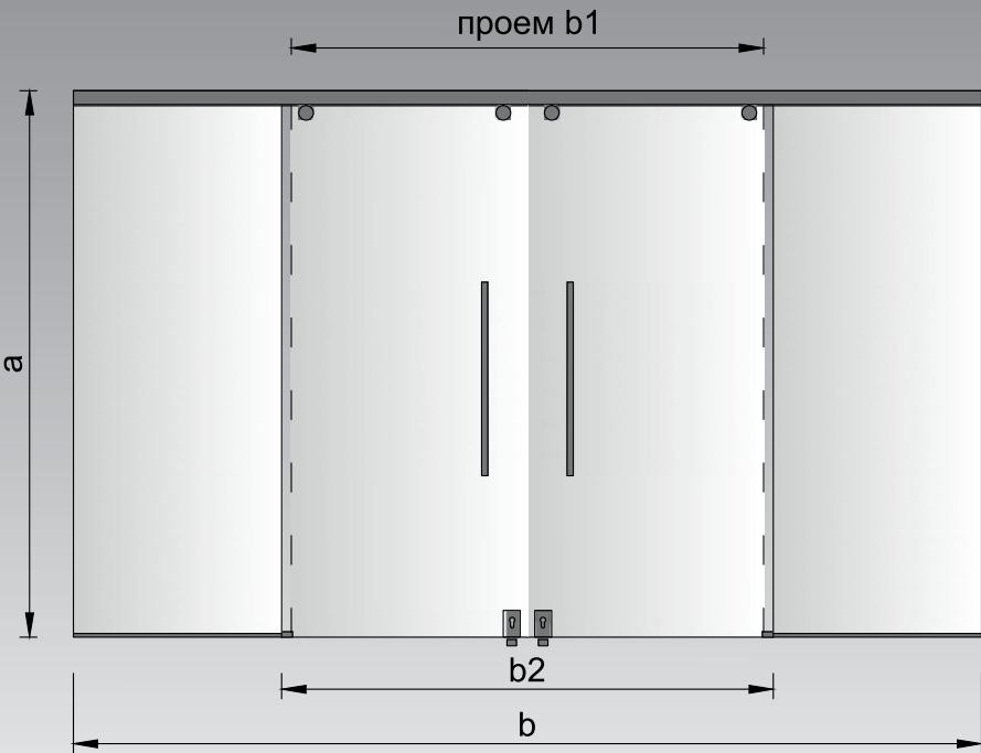
С. Стандартные конструкции раздвижных дверей серии «Вектор-мини»
